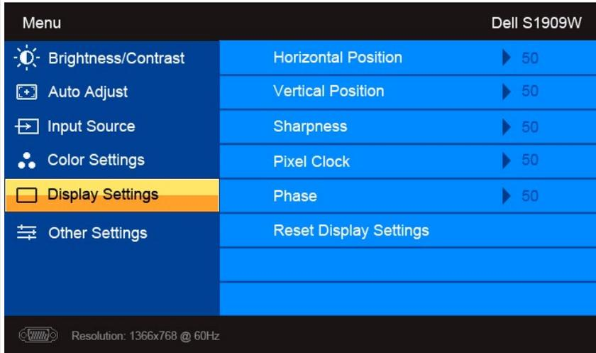
**Horizontal Position (水平位置)** 使用  $\blacktriangledown$  和  $\blacktriangle$  按钮向左/右调整图像。最小为“0”(-)。最大为“100”(+)。
