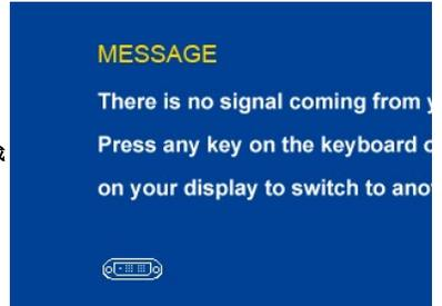
如果选择了 VGA 或 DVI-D 输入，但所有 VGA 和 DVI-D 线缆均未连接，将显示如下浮动对话框。
